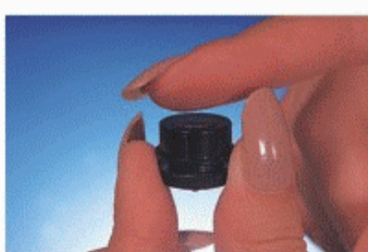
Figure 4. Appliquer par le bout du doigt une goutte de salive (exempte de bulles) sur le verre, déposer l'oculaire sur une surface plane et laisser sécher 10-15 minutes
