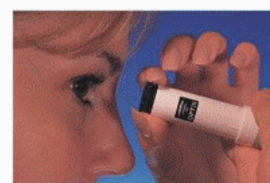
Figure 5. Remettre l'oculaire dans la boîte et porter le microscope près de votre oeil. Par le doigt d'une main appuyer sur le bouton d'éclairage (4.1) et en même temps, à l'aide des doigts de l'autre main, ajuster la netteté de l'image en tournant une partie de l'oculaire (2.1)
